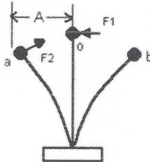
La figura representa un trozo de cinta de sierra que lleva soldado en su extremo superior una pequeña masa. Si separamos la masa hacia la izquierda una distancia (A) por medio de la fuerza F1 desde la posición (o) a la posición (a) y lo abandonamos en esta posición la masa soldada queda sometida a una fuerza recuperadora F2 ejercida por la cinta de sierra dirigida a la posición de equilibrio (o). El objeto efectúa 120 oscilaciones completas en un minuto y su máxima elongación es de 5cm.
