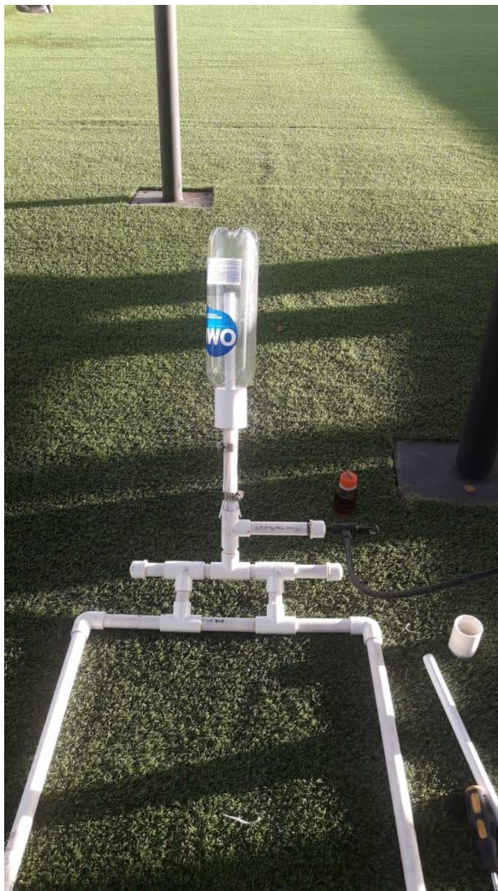
Imagen 2: Lanzadera casera y posicionado de la botella.
